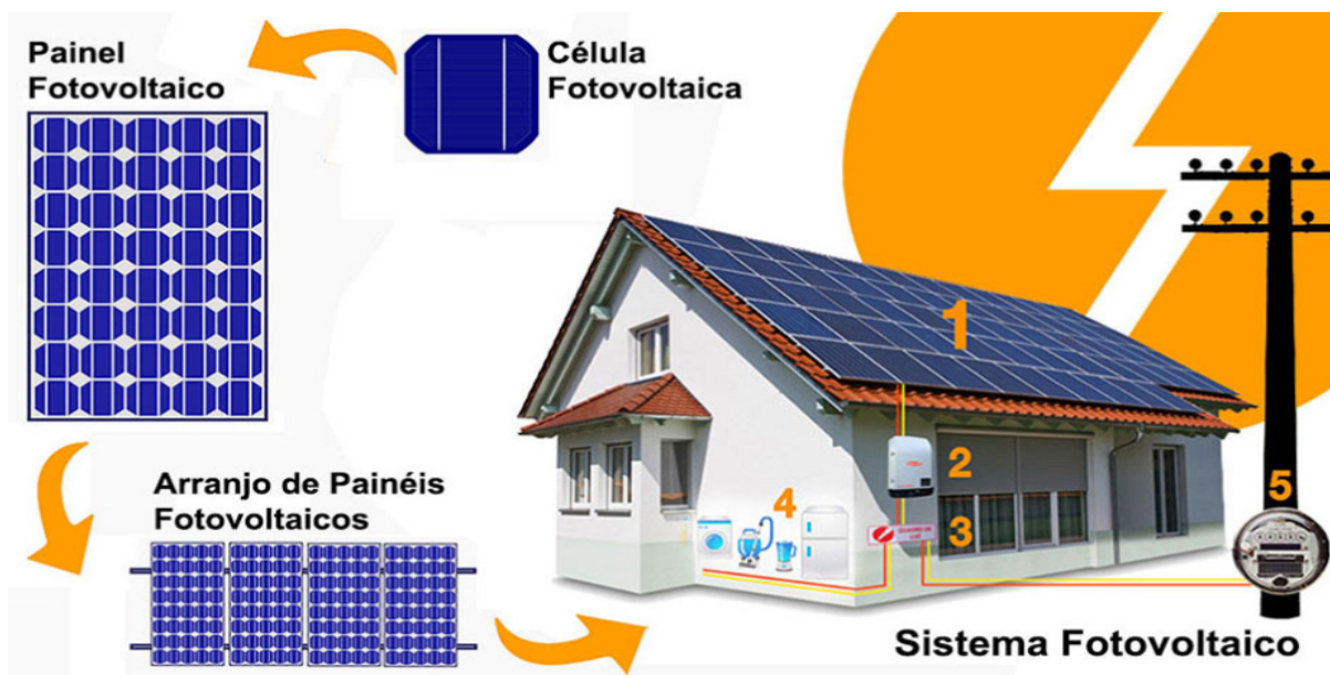
Figura 7 – Sistema conectado à rede.
